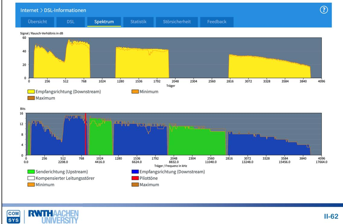
Beispiel DSL: dargestellt ist hier ein Beispiel der Signalqualität in Abhängigkeit der Frequenz bei einer DSL-Leitung. In Relation dazu sieht man im unteren Teil der Abbildung die erzielte Datenrate auf der Leitung – bei höherem Signal/Rausch-Abstand hat man die Möglichkeit, mehr Signalstufen zu verwenden und erzielt damit höhere Datenraten.
